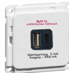
USB Lader, 2-fach, 5 V, 3000 mA, max.15W Gesamtleistung, 2 x USB Buchsen vorne (1x USB A, 1x USB-C), 2,5 mm<sup>2</sup> **Steckklemmen**, 230 V, 0,07 W Standby, Click 45, einrastbar horizontal, 2-modulig, halogenfrei, Farbe **weiß glänzend** ähnlich RAL 9003
