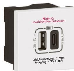
USB Lader, 2-fach, 5 V, 3000 mA, max.15W Gesamtleistung, 2 x USB Buchsen vorne (1x USB A, 1x USB-C), 2,5 mm<sup>2</sup> **Steckklemmen**, 230 V, 0,07 W Standby, Click 45, einrastbar horizontal, 2-modulig, halogenfrei, Farbe **weiß glänzend** ähnlich RAL 9003
