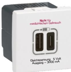
USB Lader, 2-fach, 5 V, 3000 mA, max.15W Gesamtleistung, 2 x USB Buchsen vorne (1x USB A, 1x USB-C), 2,5 mm<sup>2</sup> Schraubklemmen rückseitig, 230 V, 0,07 W Standby, Click 45, einrastbar horizontal, 2-modulig, halogenfrei, Farbe **weiß glänzend** ähnlich RAL 9003
