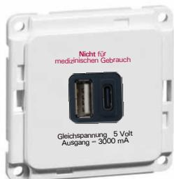
USB Lader, 2-fach, 5 V, 3000 mA, max.15W Gesamtleistung, 2 x USB Buchsen vorne (1x USB A, 1x USB-C), 2,5 mm<sup>2</sup> Schraubklemmen rückseitig, 230 V, 0,07 W Standby, Click 45, einrastbar horizontal, 2-modulig, halogenfrei, Farbe **weiß glänzend** ähnlich RAL 9003
